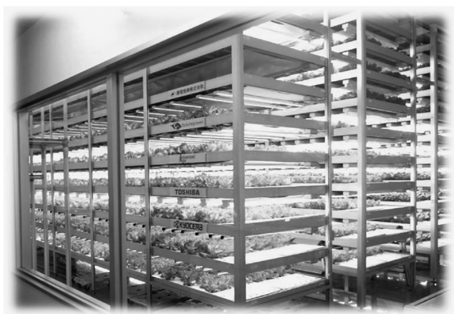
写真1 人工光型植物工場の一例（栽培棚10段、リーフレタス生産）（千葉大学・柏の葉キャンパス内）
